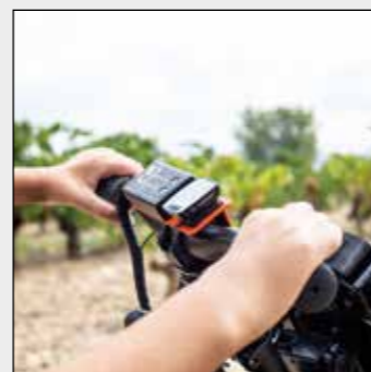
Guidon Gas & Brake sans manettes*: qui permet d'accélérer et de freiner moyennant de simples mouvements de guidon.
