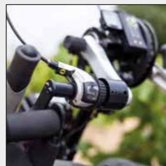
Moyeu à vitesses pour tétraplégiques BATEC SHIFT LEVER (brevet déposé)**: il peut s'activer facilement sans enlever les mains des pédales.
