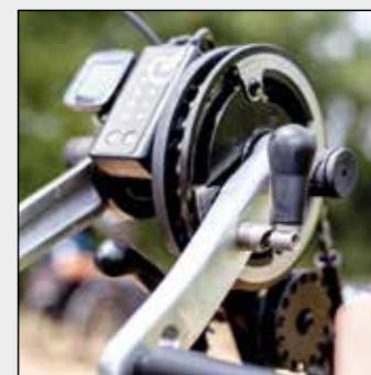
Système de libération de bielles BATEC MAGIC LEVER (brevet déposé)***: il offre une aide au démarrage afin que les utilisateurs puissent utiliser le Batec en mode zéro effort.
