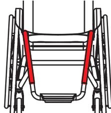
(L'anteriore a V e' possibile solo con pedana regolabile in inclinazione chiusa)
